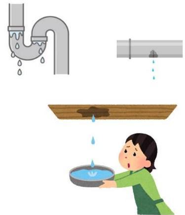
排水管からの水漏れの多くは、排水管に油カスなどが溜まって詰まり気味になった所へ水が滞留してしまい、排水管の劣化を促進させてしまうことが原因です。
